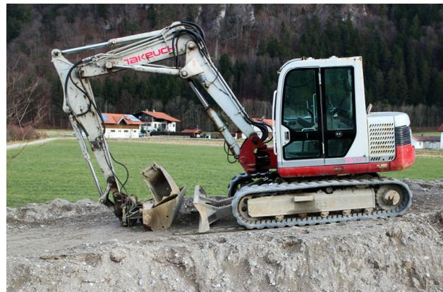
Abb. 4: Bagger für Anlegen von Kabelgräben
