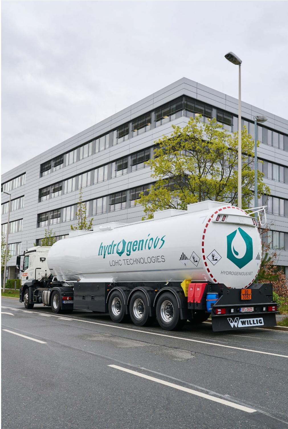
(2) Der neue LOHC-Tankwagen von Tankfahrzeughersteller Kurt Willig GmbH & Co. KG bedient die LOHC Logistik und transportiert sowohl das mit Wasserstoff beladene LOHC als auch das unbeladene Material gleichzeitig, dank seines Mehr-Tank-Kammern-Systems.
