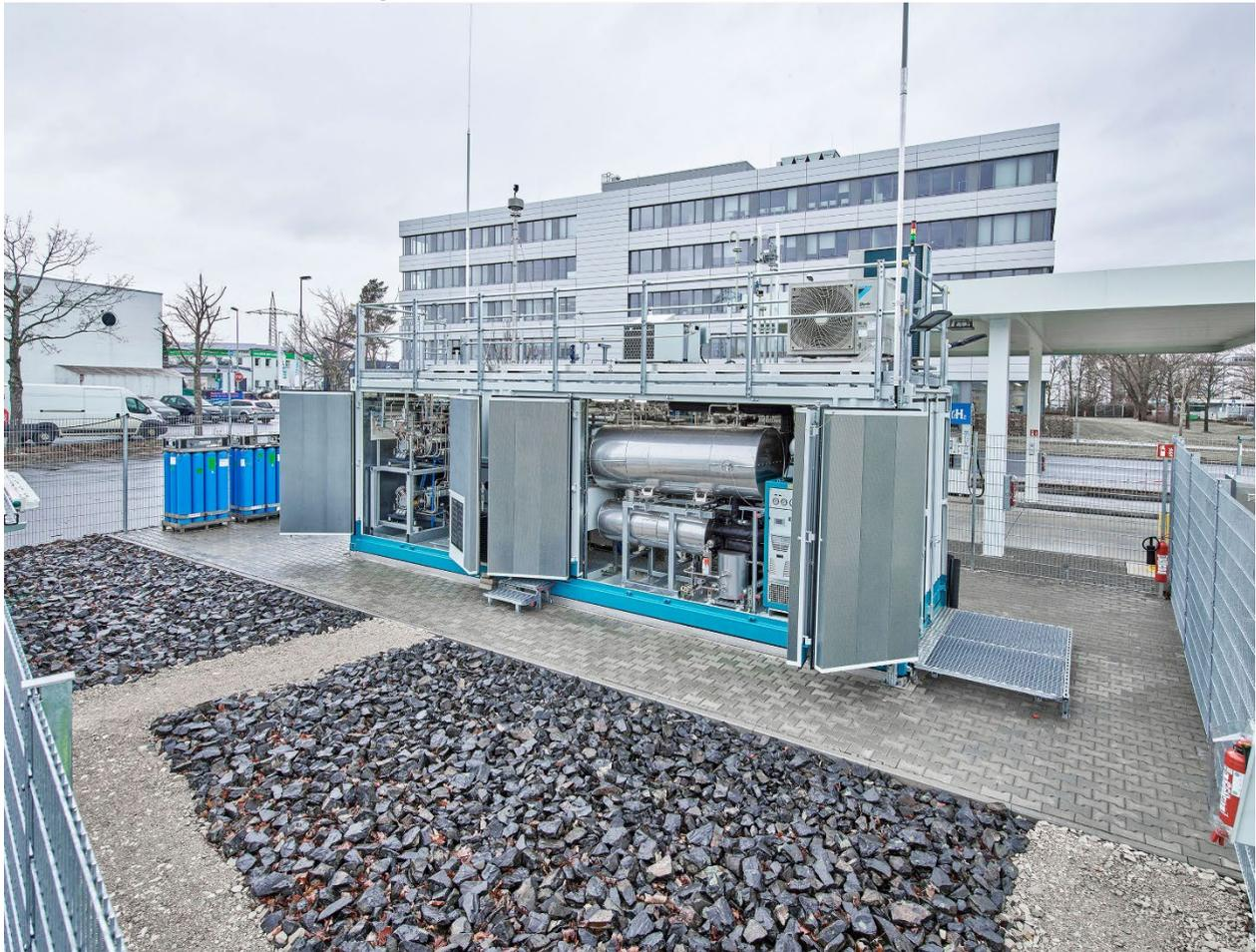
(1) Die im Demonstrationsprojekt H2Sektor an der Wasserstofftankstelle Erlangen arbeitende kleine Dehydrier- bzw. Freisetzungsanlage (ReleaseBox 10) setzt stündlich rund ein Kilogramm Wasserstoff aus rund 20 Litern LOHC-Material frei. Seit 2022 verfolgt Hydrogenious die Entwicklung von deutlich größeren Freisetzungsanlagen in einem Leistungsbereich von mind. 1,5 Tonnen Wasserstoff/Tag. ©Hydrogenious LOHC Technologies.
